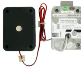
5. Coloque la tapa del compartimento sobre la carcasa y fijela con el tornillo que retiró anteriormente. Use una brida para fijar el cable de alimentación que se encuentra cerca del compartimento de las pilas. Estire fuertemente de la brida para que el cable quede bien sujeto.
