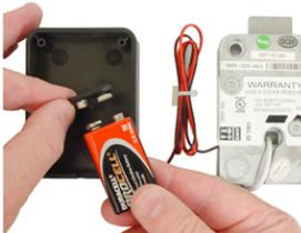
3. Pase el cable de alimentación desde la carcasa de la cerradura hasta el compartimento de la pila. Sujete y fije el cable restante con bridas y anclajes para cables. Conecte una pila de 9 voltios en el conector de la pila del extremo del cable.
