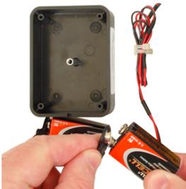
4. Bündeln und fixieren Sie im Inneren des Safes das restliche Kabel mit Binddraht und Kabelbindern. Schließen Sie am Kabelende die beiden 9-Volt-Batterien an den Batterieanschlüssen an.
