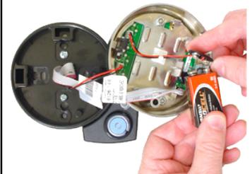
3. Noch während Sie das Tastaturfeld in Ihrer Hand halten, können Sie den Schlosscode eingeben. Öffnen Sie den Safe, um Zugriff zum Batteriefach zu erhalten. Wechseln Sie nun die Batterien. S&G empfiehlt die Verwendung von Alkalibatterien der Marken Duracell® oder Procell®.
