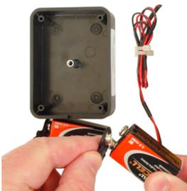
4. Bündeln und fixieren Sie im Inneren des Safes das restliche Kabel mit Bindedraht und Kabelbindern. Schließen Sie am Kabelende die beiden 9-Volt-Batterien an den Batterieanschlüssen an.
