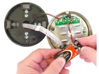
3. Noch während Sie das Tastaturfeld in Ihrer Hand halten, können Sie den Schlosscode eingeben. Öffnen Sie den Safe, um Zugriff zum Batteriefach zu erhalten. Wechseln Sie nun die Batterien. S&G empfiehlt die Verwendung von Alkalibatterien der Marken Duracell® oder Procell®.
