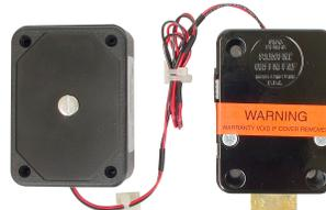
6. Die Abdeckung nun auf das Fach aufsetzen und mit der zuvor entfernten Schraube anschrauben. Achten Sie darauf, das Kabel neben dem Batteriefach mithilfe von Bindedraht und Kabelbindern zu fixieren. Ziehen Sie den Kabelbinder so fest zusammen, dass er auch als Zugentlastung für das Kabel dient.
