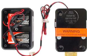
5. Coloque las pilas dentro del compartimento. Asegúrese de que el cable de alimentación se encuentre en la ranura del extremo del compartimento de la pila antes de volver a colocar la tapa.
