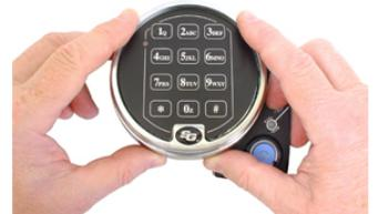
2. Cuando el teclado se suelte de la base, conecte una pila nueva de 9 voltios al conector vacío de la parte inferior del teclado numérico.
