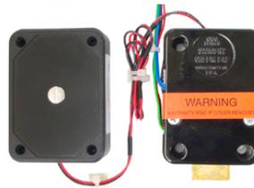
6. Coloque la tapa del compartimento sobre la carcasa y fijela con el tornillo que retiró anteriormente. Use una brida para fijar el cable de alimentación que se encuentra cerca del compartimento de las pilas. Estire fuertemente de la brida para que el cable quede bien sujeto.
