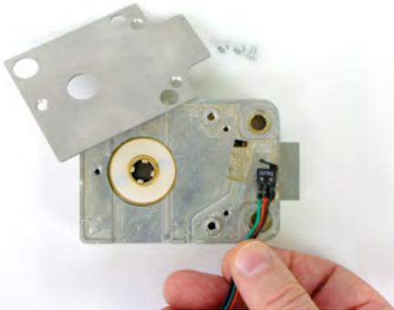
3. El interruptor preconectado tiene dos agujeros justo debajo del pequeño brazo de la palanca. Estos dos agujeros van encima de dos postes que forman parte de la estructura de la cerradura, con el brazo de la palanca orientado como aparece en la imagen. Esta fotografía fue tomada sin la pequeña almohadilla de espuma colocada en la parte delantera del interruptor con el fin de que se vean los dos agujeritos.
