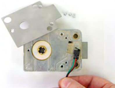
4. El interruptor está equipado con una pequeña pieza de espuma en la parte delantera, tal como vemos aquí. La espuma ayuda a mantener el interruptor en la cavidad de la cerradura cuando unimos la tapa de acero.
