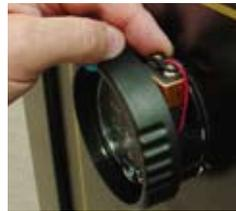
Die Schlossbatterie befindet sich zum einfachen Zugriff für den Batteriewechsel in einem speziellen Fach im Zahlenfeld.
