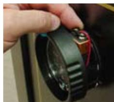
La pila de la cerradura se encuentra en un compartimento especial dentro del teclado, desde donde se puede cambiar fácilmente.
