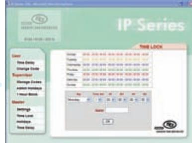
Contrôle l'accès aux coffres en configurant facilement la serrure à horloge, soit à partir de l'interface du navigateur, soit à l'aide du logiciel LMP.
