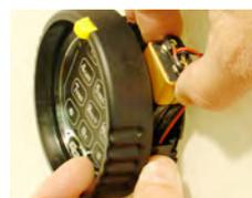
14. Pour installer la pile, tirez légèrement sur la languette jaune, tournez l'anneau du clavier dans le sens inverse des aiguilles d'une montre et tirez le vers vous. L'anneau révélera le connecteur de la pile. Branchez la pile et placez-la dans son compartiment.
