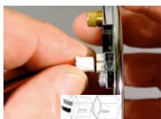
7. S'il n'est pas déjà fixé, enfoncez le câble de connexion de la pile dans la prise blanche à l'arrière du clavier.
