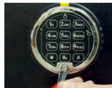
12. Installez et resserrez le clavier en maintenant la vis comme sur la photo. Utilisez la vis de sécurité antivol pour des applications VdS. La vis Phillips (cruciforme) est acceptable pour toutes les autres applications. Une fois la vis en place, cachez-la avec le logo S&G autocollant après avoir ôté le film protection du logo.
