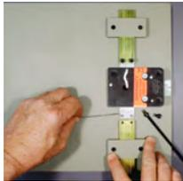
5. Ici, les pènes de serrure sont directement fixés sur les extensions de barre de verrouillage. Les trous de fixation des extensions sont adaptés à des vis #8 ou M4. Une fois le pavé numérique tourné, le pêne de serrure et les extensions se déplacent vers le boîtier de verrouillage en emmenant les verrous avec eux.
