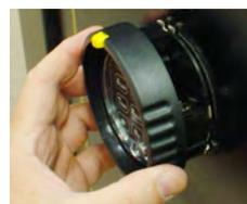
13. Placez l'anneau du clavier par dessus le socle du pavé numérique. Tournez-le légèrement dans le sens inverse des aiguilles d'une montre pour l'insérer. Une fois sur le socle, tournez-le dans le sens des aiguilles d'une montre jusqu'au clic. La languette jaune doit être à 12h00.
