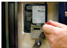
4. Placez l'extrémité du câble de verrouillage à travers la porte par l'intérieur. En appuyant sans forcer sur le câble, insérez la serrure et sa tige dans la porte afin de la fixer sur la plaque de montage avec les trois vis fournies.
