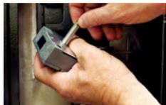
3. Après avoir glissé le bout du câble dans la fente de la tige, placez le câble dans la came de la serrure. La tige et la came sont configurées pour s'insérer l'une dans l'autre.
