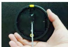
6. En appuyant sans forcer sur le câble, placez le clavier contre la porte, fixez avec les deux vis fournies. Ne dépassez pas un couple de torsion de 15 pouces-livres (1,695 Nm).
