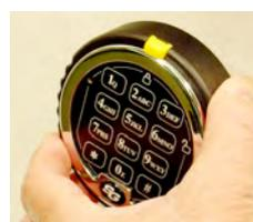
15. Repoussez l'anneau du clavier sur le socle et tournez dans le sens des aiguilles d'une montre jusqu'au clic. Testez le système de verrouillage au moins trois fois porte ouverte avant de fermer le coffre-fort.
