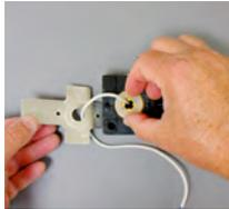
3. Retirez et écartez le joint en plastique situé sous la plaque de came. Il n'est pas utilisé quand les extensions de barre de verrouillage sont ajoutées. Ne retirez aucun des lubrifiants trouvés sous la plaque de came.
