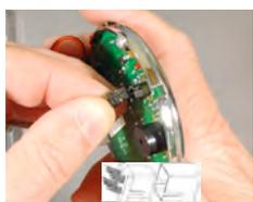
8. Enfoncez le câble de serrure dans la prise noire à l'arrière du clavier. Les deux tiges de la fiche du câble correspondent aux deux fentes de la prise. Alignez-les avant d'insérer la fiche dans le réceptacle. (détrompeur)
