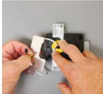
4. Placez les extensions dans les rainures prévues à cet effet. Ajustez les petites pattes d'extension dans les ouvertures de la came correspondantes. Une fois les extensions en place, remettez la plaque de came dans sa position initiale. Fixez-la avec les deux vis d'origine.
