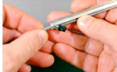
2. Insérez le câble de verrouillage dans la fente de la tige comme l'indique la photo. Puis glissez le câble sur la longueur de la fente.
