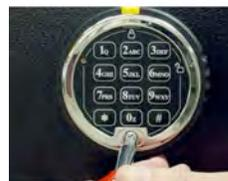
12. Sujete el teclado apretando el tornillo, según se muestra. Utilice el tornillo de seguridad de una sola dirección para las instalaciones VdS. Se puede utilizar el tornillo Phillips para todas las aplicaciones. Cuando el tornillo esté colocado, cúbralo con el logotipo S&G adhesivo tras retirar la película de protección del logo.
