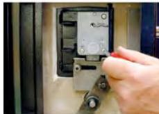
4. Coloque el extremo del cable de la cerradura a través de la puerta de la caja fuerte desde el interior. Tirando suavemente del cable, introduzca la cerradura con el eje colocado a través de la puerta de la caja fuerte, de modo que pueda fijarse a la placa de montaje de la puerta con los tres tornillos incluidos.
