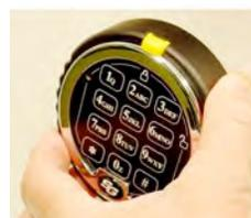
15. Vuelva a empujar el teclado contra la base y gírelo en sentido horario hasta oír un clic. Compruebe el funcionamiento de la cerradura un mínimo de tres veces con la puerta abierta antes de cerrar la caja fuerte.
