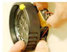
14. Para instalar la pila, tire de la pestaña amarilla ligeramente y gire el anillo del teclado en sentido antihorario. El anillo se separará de la base lo suficiente para que quede expuesto el conector de la pila. Conecte la pila y colóquela en su compartimento.
