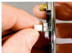
7. Conecte el cable del conector de la pila en el receptáculo blanco de la parte trasera del teclado. (Observar la posición adecuada según la ranura en los conectores)
