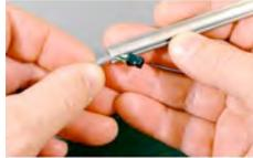
2. Introduzca el cable de la cerradura en la ranura del eje, según se muestra. A continuación, deslice el cable a través de toda la longitud de la ranura.
