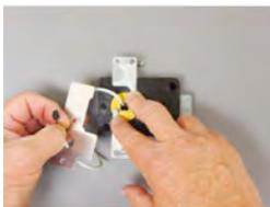
4. Coloque las básculas en los huecos dispuestos para ello. Apoye las pestañas pequeñas de las básculas en las aberturas correspondientes de la pieza de arrastre. Con las extensiones en su posición, vuelva a poner la placa que cubre la pieza de arrastre en su posición original. Fijela en su posición con los dos tornillos retirados anteriormente.
