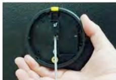
6. Tire suavemente del cable, ajuste la base de teclado contra la puerta de la caja fuerte, y sujétela utilizando los dos tornillos incluidos. No apriete más de 15 pulgadas-libras (1,695 dNm).
