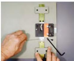
5. Aquí, los tornillos de las barras verticales se fijan directamente a las básculas de la cerradura. Los orificios de fijación de las básculas se colocarán con tornillos nº 8 o M4. Según se gire el teclado, el pestillo de la cerradura y las básculas se moverán girando los bulones de la caja con estas.
