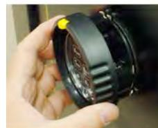
13. Coloque el anillo del teclado sobre la base y el teclado. Debe hacerse ligeramente en sentido antihorario, de modo que se ajuste fácilmente en la base. Una vez colocado sobre la base, gírelo en sentido horario hasta oír un clic. La pestaña amarilla deberá quedar en la posición de las 12 en punto.
