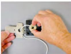
3. Suelte y tire la arandela plástica situada bajo la placa de la pieza de arrastre. No se utiliza cuando se añaden las básculas de la barra de cierre. No quite nada del lubricante que encuentre bajo la placa.
