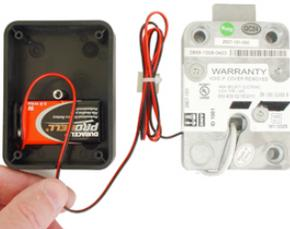
4. Setzen Sie die Batterie in das Batteriefach ein. Achten Sie vor dem Aufsetzen des Deckels darauf, dass das Kabel im Kanal am unteren Ende des Batteriefaches verläuft.
