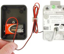
4. Coloque a bateria dentro da caixa. Certifique-se de que o cabo da energia está no encaixe ao final da caixa da bateria antes de colocar a tampa sobre a caixa.
