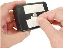
2. Selecione um bom lugar para a caixa da bateria, na parte de trás da porta do cofre, na parte interna do cofre. Certifique-se de que os fios de energia do corpo da fechadura alcancem a caixa e que os fios não entrem em contato com partes móveis. Use a almofada com álcool incluída para limpar a superfície do cofre onde a caixa vai ser montada, depois retire a fita protetora das almofadas com fita dupla face na parte de trás da caixa da bateria e monte-a no cofre. Pressione firmemente no lugar.
