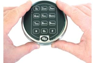
2. Une fois le clavier hors de sa base, connectez une pile 9 volts neuve au connecteur vide situé sur la partie inférieure du clavier.
