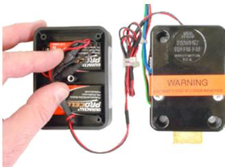
5. Placez les piles à l'intérieur de la boîte. Veillez à ce que le câble d'alimentation se trouve bien dans l'encoche en bas du boîtier avant de remettre le couvercle.
