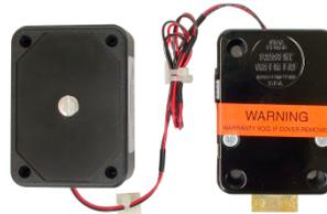
6. Placez le couvercle sur le boîtier et fixez-le à l'aide de la vis enlevée lors de la première étape. Veillez à fixer le câble d'alimentation à proximité du boîtier à pile à l'aide d'un serre-câbles et d'un bloc. Serrez bien le serre-câbles afin d'éviter les tensions sur le câble.
