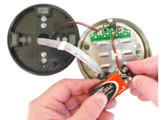
3. Vous pouvez entrer le code pendant que vous tenez le clavier. Ouvrez le coffre afin d'accéder au boîtier et de changer les piles. S&G recommande les piles alcalines Duracell® ou Procell®.
